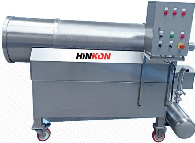
Le fromage est filtré et traité depuis l'intérieur du tambour et sort à travers un système en spirale. La vitesse de rotation du tambour est réglable. Le lactosérum est collecté dans une cuve placée sous le tambour.
